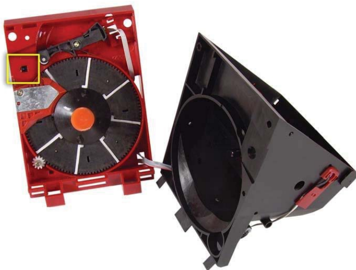
Figura 27. Limpieza Hopper U-II
