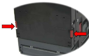
Figura 5: Apertura de la compuerta del Note Float
